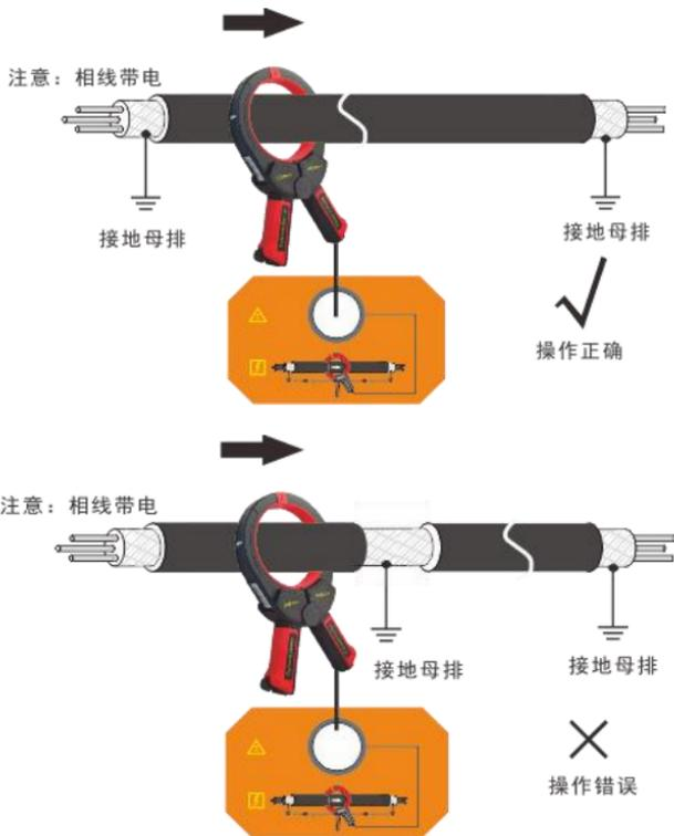
本方法适用于普通三相统包运行电缆的探测。发射机输出接卡钳，将卡钳卡住电缆本体（注意不能卡接地线以上部分），卡钳等效为变压器的初级，电缆金属护套 - 大地回路等效为变压器的次级（单匝），次级耦合电流的大小与回路电阻（主要是两端的接地电阻）密切相关，电阻越小，电流越大，如果接地回路总电阻超过 200 欧姆时将无法识别。电缆通过卡钳耦合得到的电流较小，为加强探测效果，接收机增益调至最大，耦合电流小于 0.3mA 时不能使用。
