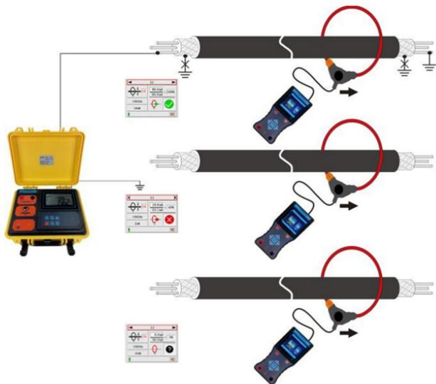
在进行带电识别或停电识别，不要将柔性电流钳的线圈接口处靠近线缆进行测量，以免造成误差。
