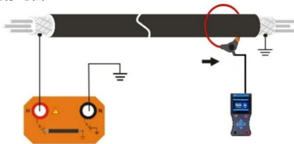
发射机电流流经屏蔽层，在远端的进入大地，再经过大地返回到发射机。同样，由于屏蔽层和大地之间存在电阻和分布电容，随距离的增加，电流会逐渐减小。
