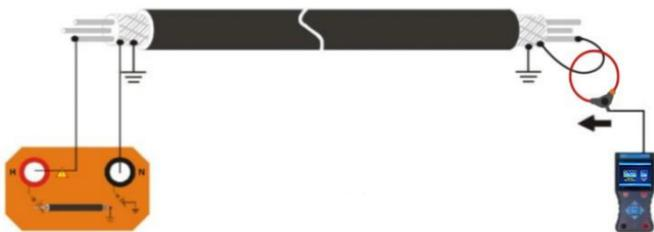
如果是单条电缆敷设，信号自发射机流经芯线，再经护层和大地两个回路返回。因为护层（铠装及铜屏蔽层）由连续金属组成，电阻很小；大地回路由于存在两端接地电阻，再加土壤电阻，总阻值较大；另外由于芯线 - 护层回路和护层 - 大地回路存在互感，通过电磁感应也能够在护层 - 大地回路产生感生电流。导致有效电流大幅减少，信号较弱，而且有效电流中含有感应电流成分，目标电缆和邻近管线的感应信号相位相同，有可能无法根据电流方向排除邻线干扰。
