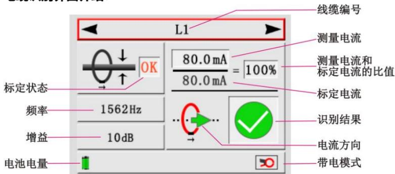
**接收机**进入电压电流测量界面，屏幕显示交流电压大小、交流电流大小、交流电流频率和电池电量信息。
